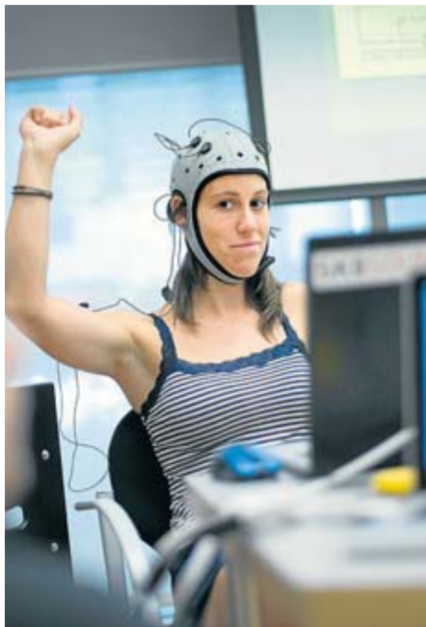
El casc s'anomena Enobio i envia els senyals del cervell a un ordinador. FRANCESC MELCIÓN
